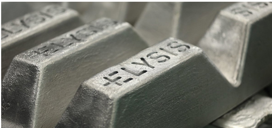
Lingots d'aluminium produits à partir d'un procédé d'électrolyse quasi exempt d'émissions de GES
